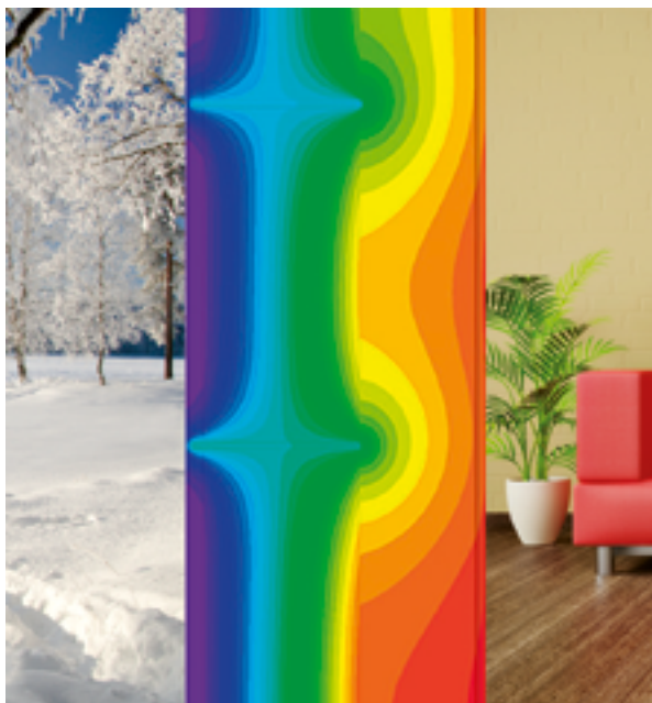
Abbildung 1 Ausgeprägte Wärmebrücke bei Aluminiumkonsolen
