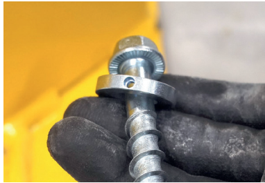
1.) Passende Verfüllscheibe zusätzlich zur Betonschraube montieren.
