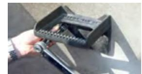
6. Posizionare l'ancoraggio per gradini e serrare con una chiave dinamometrica con  $T_{inst} = 25 \text{ Nm}$ .
